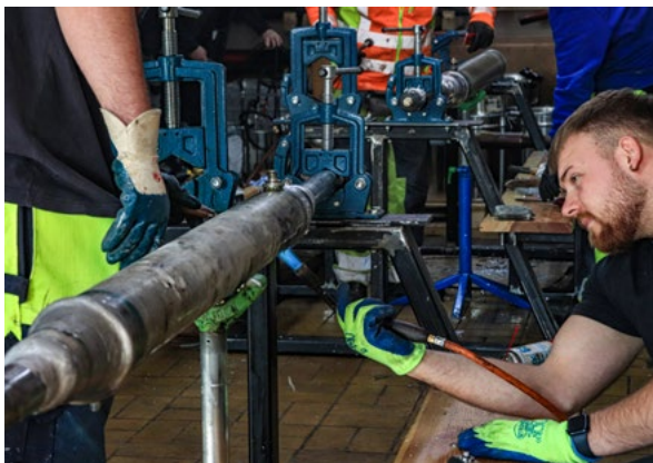
⌵ Weiterbildung zur Montage von 110kV-Ölkabeln in Zusammenarbeit mit der CEN GmbH
