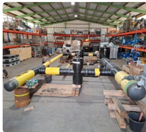
Vorfertigung des Schieberkreuzes der Gashochdruckleitung in der Werkhalle
